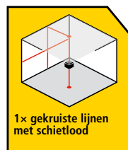
Hellingsgraad +/- 10% met verticaal punt en schietlood
